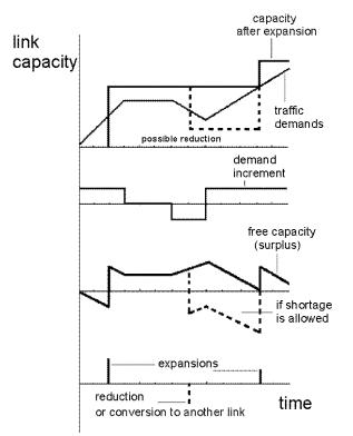
Figure 1 Capacity planning for only one capacity type over the finite time period Slika 1. Planiranje kapaciteta za samo jednu vrstu opreme i za konačni broj perioda
