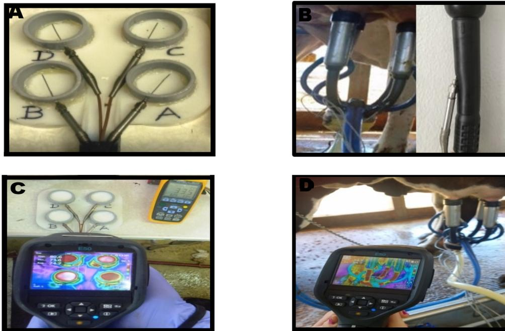
Figura 1. Paleta de CMT modificada (panel A) y unidad de ordeño (panel B) modificadas con sonda termal (HYP3-16-1-1/2-T-U-48-RP) en cada taza y tubo corto, respectivamente. Representación de la toma de imágenes termográficas en muestras de leche (panel C) y unidad de ordeño (panel D) usando la cámara termográfica FLIR modelo E-50.
