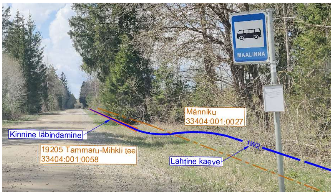
Joonis 3.4. Piltjoonis maakaablitrassist 19205 Tammaru-Mihkli tee servas. Joonis on illustreeriv ja ei ole mõõtkavas.
