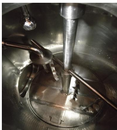
Figura 6 – Tina de clarificação
