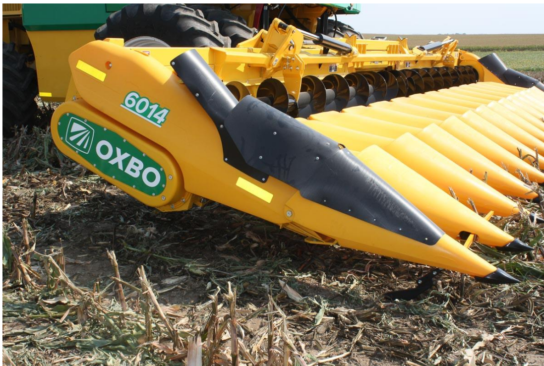
Figura 8 - Implemento para colheita de espiga de milho, plataforma articulada Oxbo série 60.
