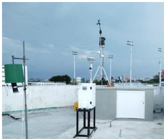
Figura 14. Estación meteorológica ubicada en la azotea del bloque 9 dentro de la Universidad de la Costa. (Romero Samper & Fuentes Gutierrez, 2019)
