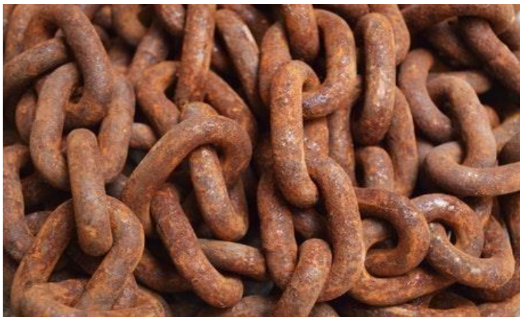
Figura 5. Ejemplo de corrosión uniforme. Morones, S. V. P. (2017) Imagen recuperada de: https://amegac.org/corrosion/
