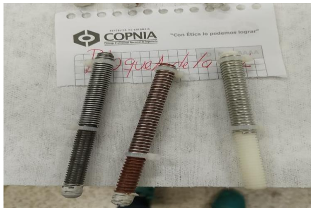
Figura 23. Probetas limpias y recién instaladas sin ningún producto de corrosión. (Paz Oñate & Vélez Mendoza, Elaboración Propia)
