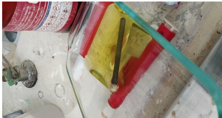
Figura 19. Proceso de limpieza de probetas de hierro en solución de ácido clorhídrico y Tetramina de Hexametileno. (Paz Oñate & Vélez Mendoza, Elaboración Propia)
