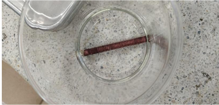
Figura 21. Probeta de cobre siendo limpiada con solución de ácido sulfámico. (Paz Oñate & Velez Mendoza, Elaboración Propia)
