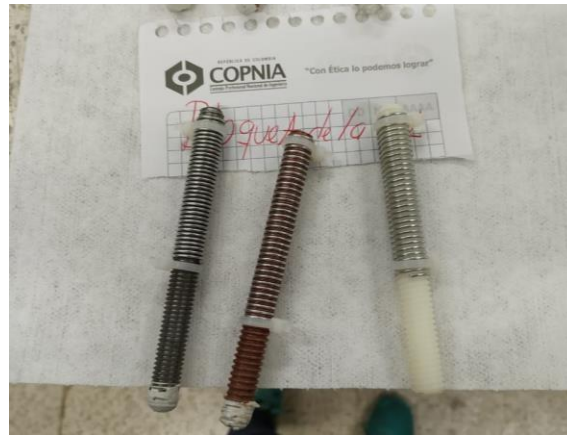
Figura 16. Probetas limpias y enrolladas a nuevos aluminios esperando ser instaladas en las diferentes estaciones. (Paz Oñate & Vélez Mendoza, Elaboración Propia)
