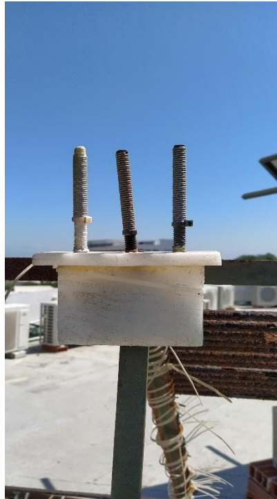
Figura 8. Ensayo CLIMAT o ensayo de “Alambre sobre tornillo”. (Paz Oñate & Velez Mendoza, Elaboración Propia)
