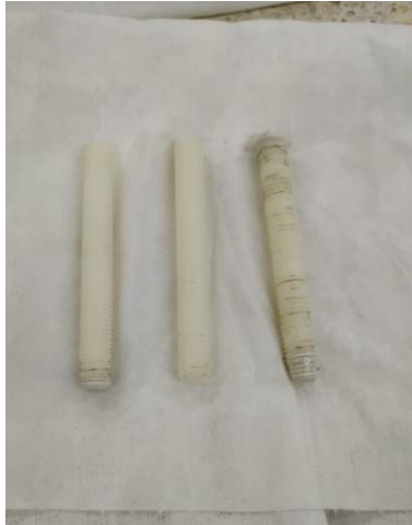
Figura 22. Probetas de PVC luego de ser limpiadas con abundante agua y jabón. (Paz Oñate & Vélez Mendoza, Elaboración Propia)
