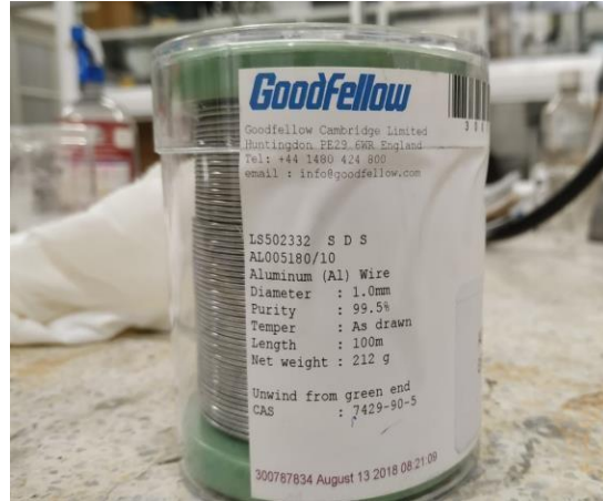
Figura 15. Aluminio 99,5% puro, utilizado para formar los pares galvánicos para el estudio. (Paz Oñate & Velez Mendoza, Elaboración Propia)
