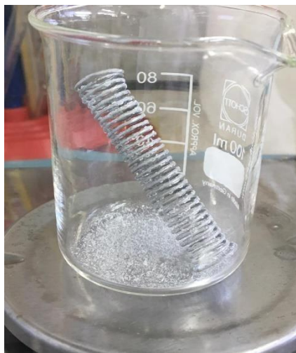
Figura 24. Aluminio retirado con evidente adherencia de productos de corrosión. (Paz Oñate & Vélez Mendoza, Elaboración Propia)
