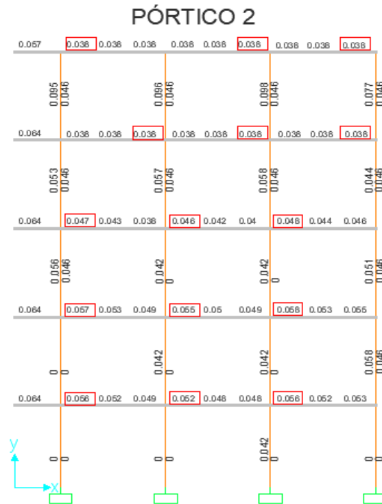
Figura 156. Diseño a Cortante ( A_v/S ) pórtico 2, combinación 1.2D+1L+1EX. Elaboración propia en SAP 2000.
