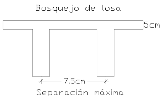
Figura 35. Bosquejo de losa e:5\text{cm} Fuente: Elaboración propia Martínez Jorge, Ospino Freddy.
