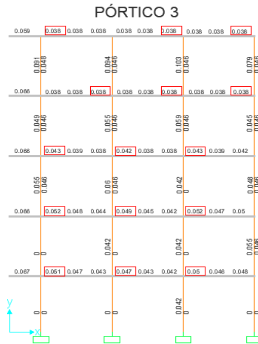
Figura 157. Diseño a Cortante ( A_v/S ) pórtico 3, combinación 1.2D+1L+1EX. Elaboración propia en SAP 2000.
