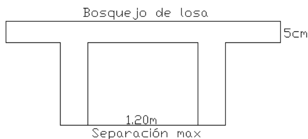
Figura 37. Bosquejo de losa e:5\text{cm} Fuente: Elaboración propia Martínez Jorge, Ospino Freddy.
