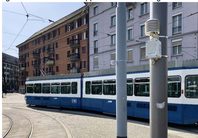
Bild 1: Temperaturmessstationen beim Hardplatz. Vordergrund Decentlab, Hintergrund "Eigenbauvariante".
