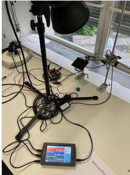
Abbildung 11: Aufbau zur Inbetriebnahme des Solarpanels
