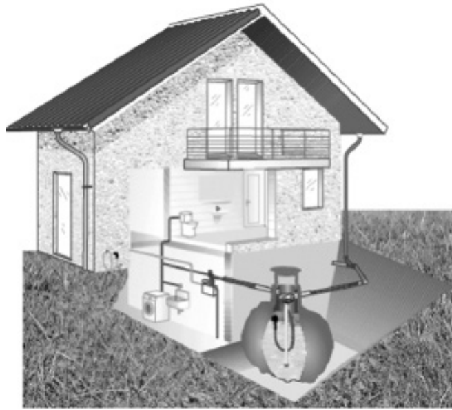
Captación y sistema de dotación de agua pluvial 7
