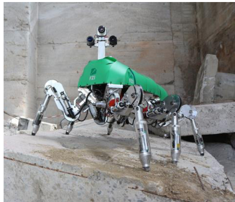
Figura 4 - Robô hexápode - LAURON V (Roennau et al., 2014).
