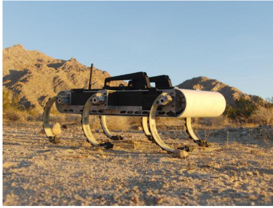
Figura 5 - Robô hexápode – RHex (Haynes et al., 2012).
