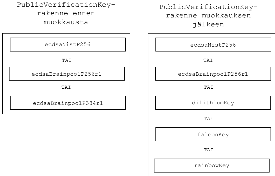
Kuva 9. Rakenteen muokkaus: sertifikaattiin sisällytettävän julkisen avaimen rakenne alkuperäisessä spesifikaatiossa ja muokattuna tätä diplomityötä varten.
