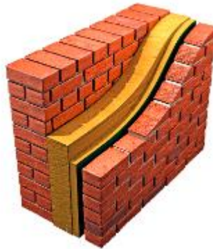
Kuva 9. Lisälämmöneristetty tuulettuva tiiliseinä (Nieminen ja Virta 2016).
