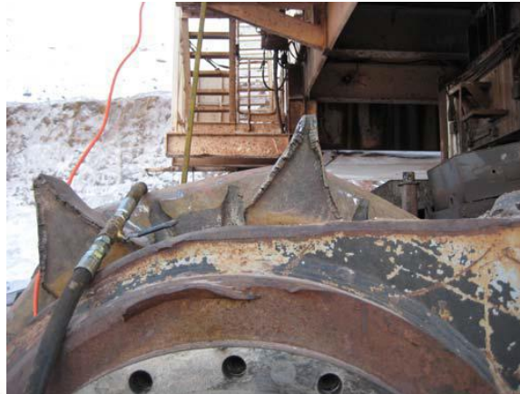
Figura 41. Desgaste excesivo de sprocket
