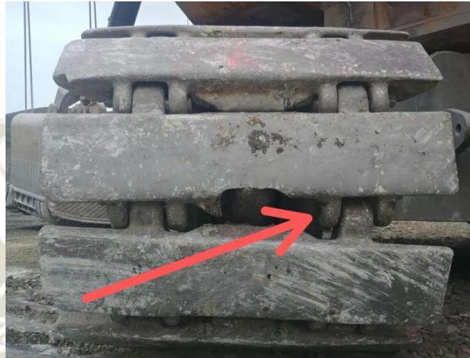
Figura 38. Caída de pin de zapata
