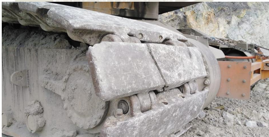
Figura 35. Rotura de zapata
