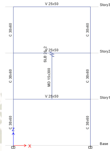
Ilustración 66 Modelo en Etabs para análisis Push Over
