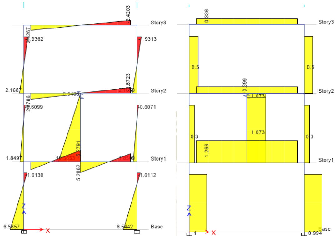
Ilustración 72 Diagrama de Momento Flector y Fuerza cortante para primer estado de carga
