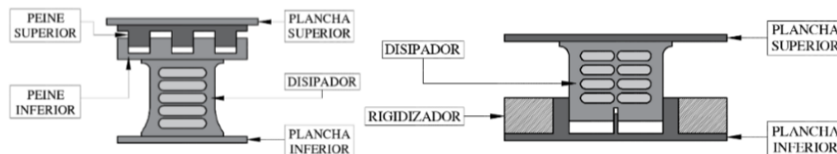
Ilustración 15 Disipador SLB con conexión tipo peine
