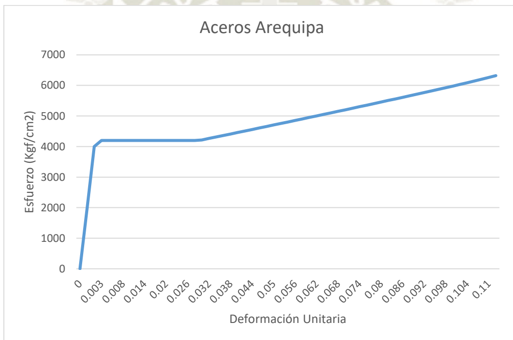
Ilustración 35 Curva esfuerzo-deformación de Acero grado 60
