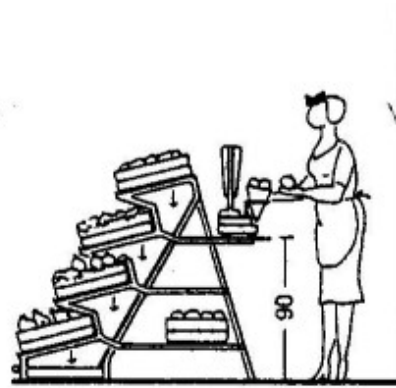
8 Puesto de venta con soporte para cajas y cestas. Chapa escurridora y bandeja de residuos
