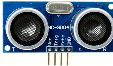
Ilustración 5.Sensor de Ultrasonidos HC-SR04 (Fuente: <https://www.hwlibre.com/hc-sr04/>)
