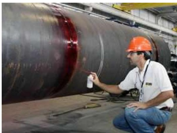
Ilustración 22. Ensayo de Líquidos penetrantes (Fuente:
