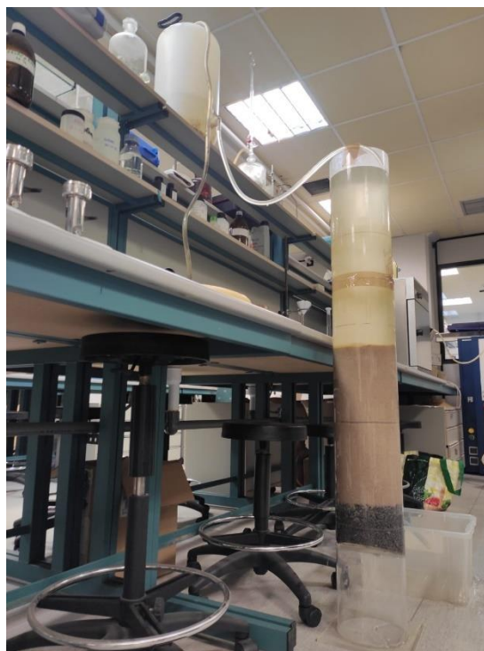
Ilustración 22. Montaje del filtro rápido de arena.
