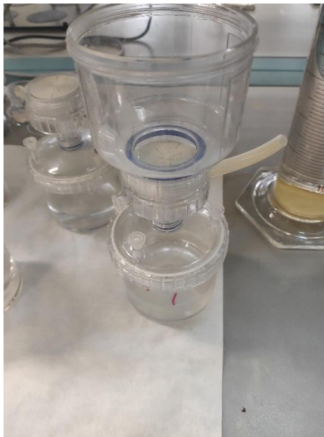
Ilustración 10. Equipo de filtración.
