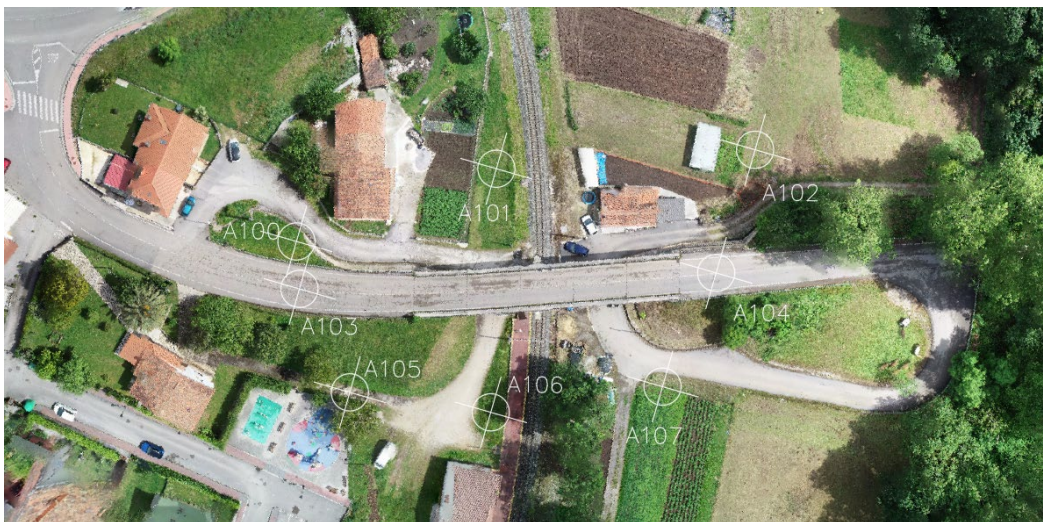
Ilustración 23- Puntos de apoyo sobre ortofoto
