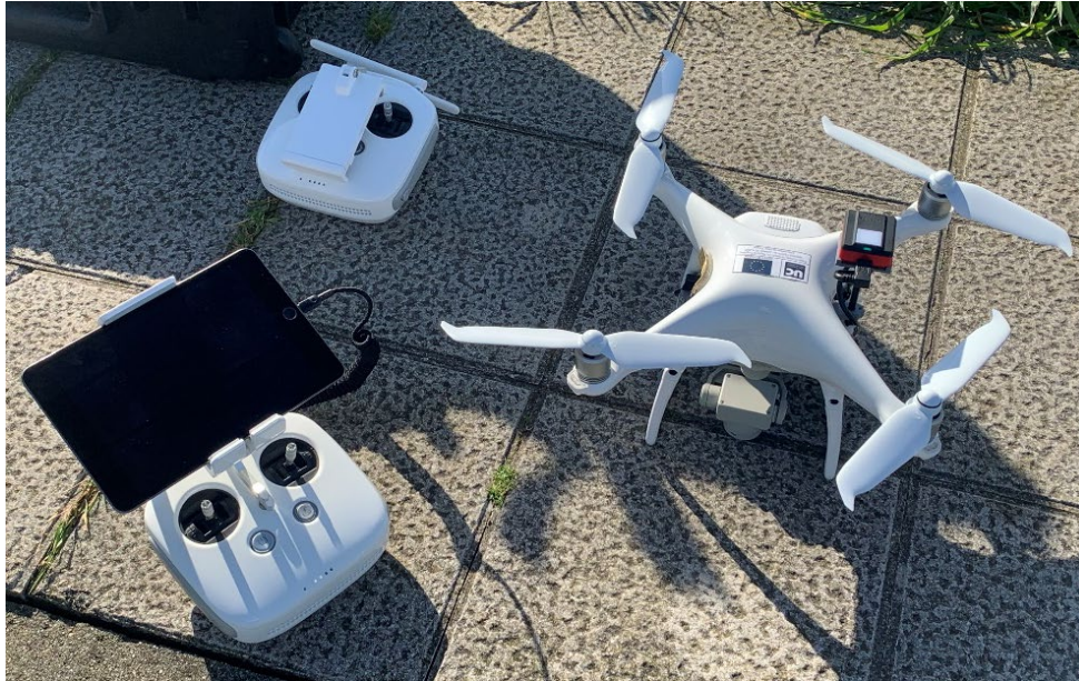
Ilustración 17- Dron Phantom utilizado
