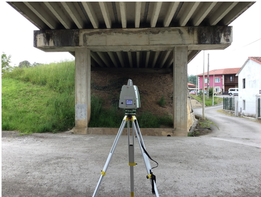
Ilustración 26- Láser escáner bajo puente
