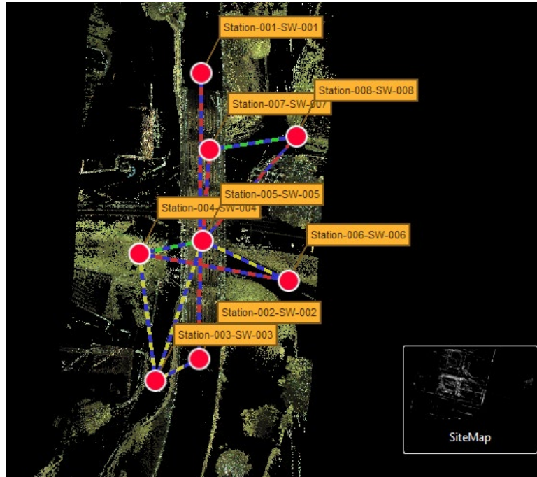
Ilustración 27- Resumen estacionamientos con láser escáner
