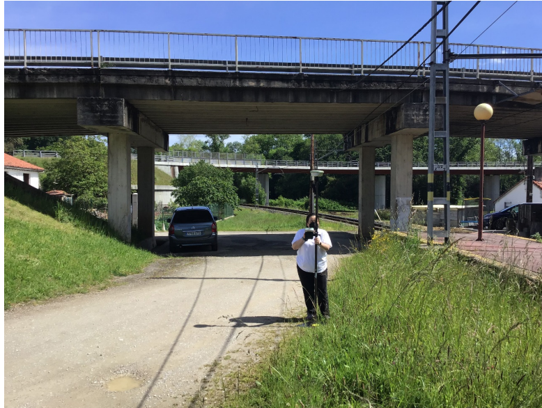
Ilustración 20- Toma de apoyos en campo junto a la estructura
