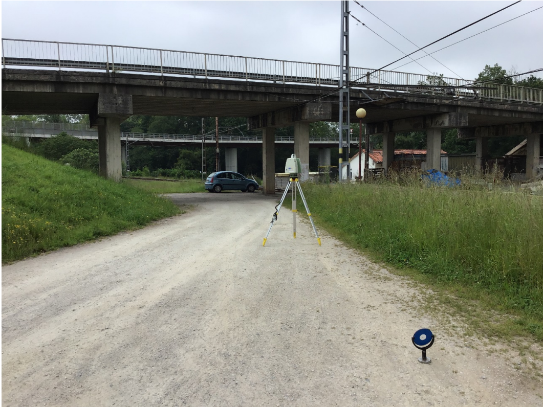
Ilustración 25- Láser escáner en funcionamiento sobre campo
