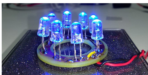
Figura 3.8. Anillo de iluminación LED utilizado para adquirir imágenes en configuración de epi-iluminación.
