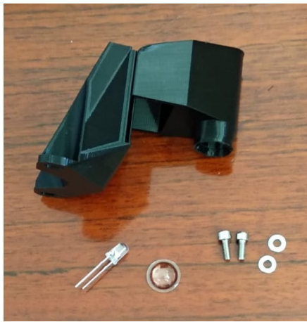
Figura 3.2. Piezas que conforman el módulo de Figura 3.3. Espectro de emisión del LED blanco iluminación del microscopio OpenFlexure. utilizado para la iluminación en transmisión.
