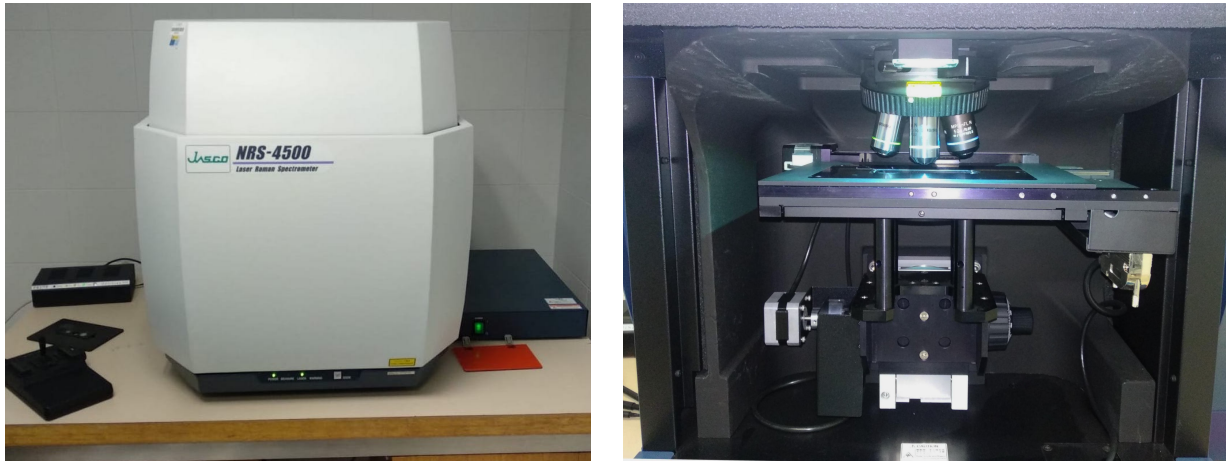
Figura 4.4. Equipo NRS-4500 JASCO con la compuerta cerrada (a) y abierta (b).
