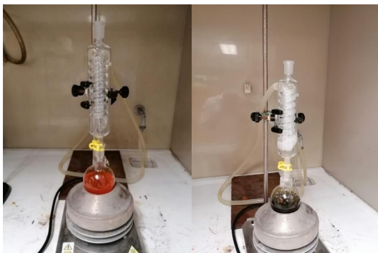
Figura 12. Etapa de oxidación hirviendo a reflujo.
