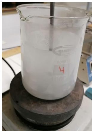
Figura 8. Tratamiento de la celulosa con palas desintegradoras y placa calefactora.
