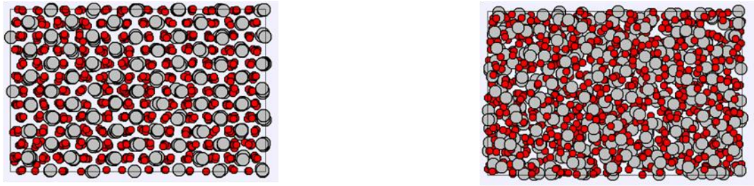
Şekil 3.3 Simülasyon sonunda elde edilen rutil yapısındaki katı faz (solda) ve sıvı faz (sağda).
