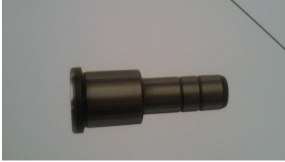
Şekil 2.2. Sertleştirilmiş olan sıfır hassasiyetli kalıp kolonu
