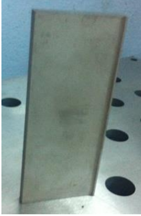
Şekil 3.23. Tel erezyon sonraki yan çakının hali
