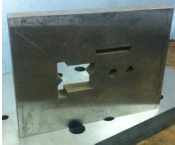
Şekil 3.24. Tel erezyon sonrası raptiyenin son hali
