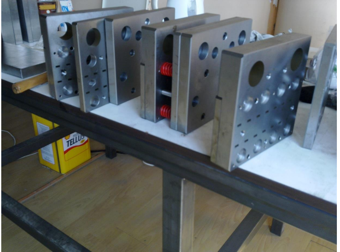
Şekil 2.9. Freze tezgahından sonraki kalıp parçalarının hali
