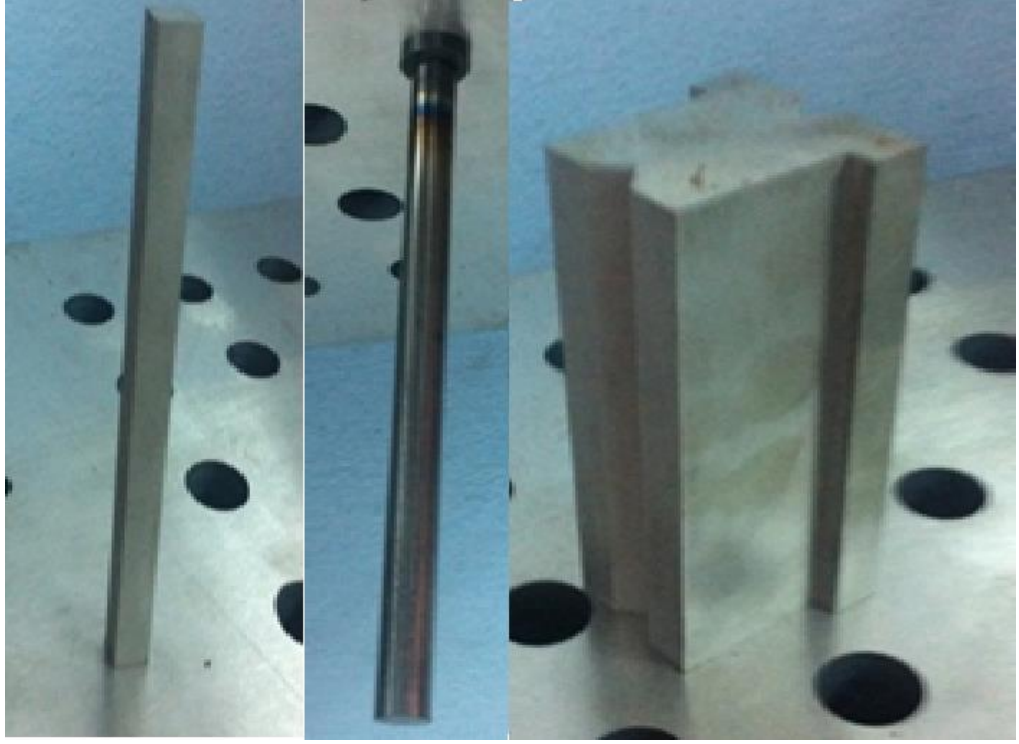
Şekil 3.22. Kalıpta kullanılacak erkeklerin tel erezyon sonraki halleri
