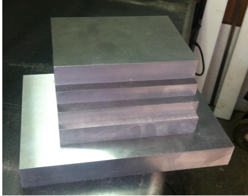
Şekil 3.19. Kalıbın Taşlama makinesinden sonraki hali
