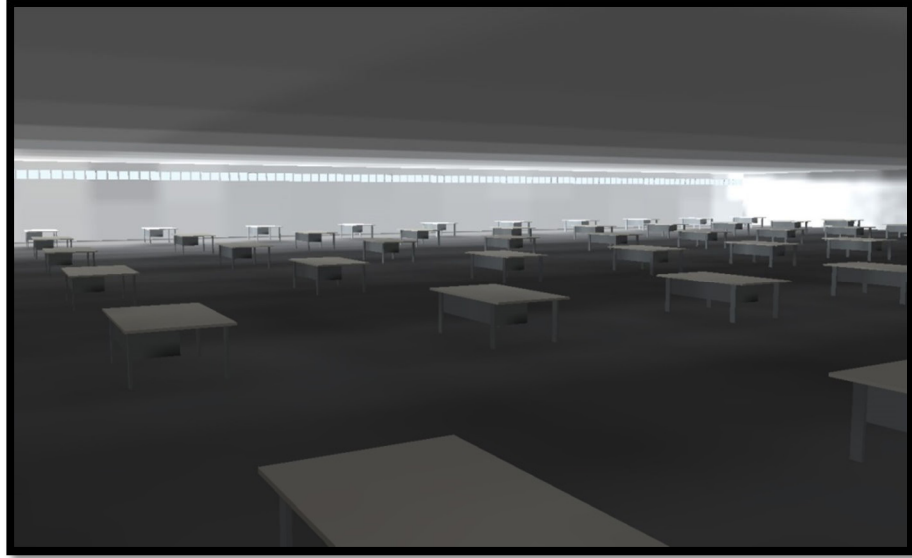
Şekil 4.11. Doğal Aydınlatmanın Yetersiz Olduğu Kısım
