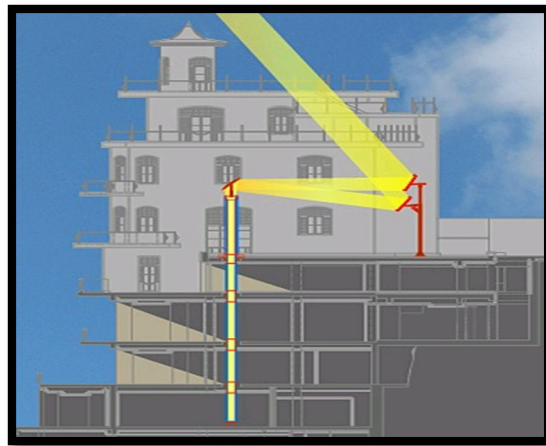
Şekil 3.10. Heliostat Sisteminin Şematik Çalışma Prensibi [39].
