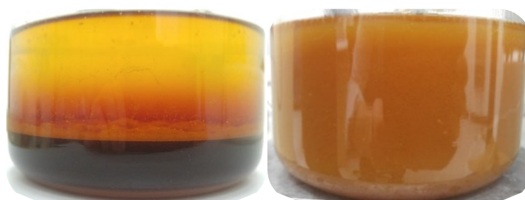
Figure V-19: Mélange hémicellulosique acidifié/1-pentanol avant (gauche) et après (droite) traitement aux ultrasons (4min de pulses (4s+1s de pause) à 480W).
