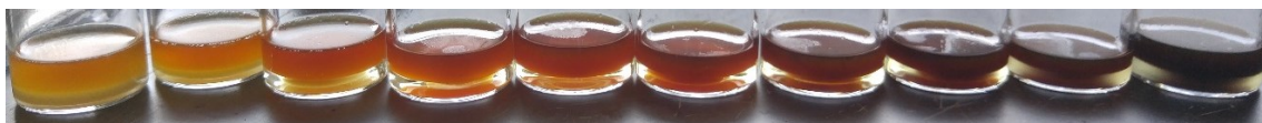
Figure V-4: Échantillons prélevés à chaque 2min de 0min (gauche) à 18min (droite). (Conditions : 200°C, ratio 1-pentanol/eau = 2, 7,5% de xylose et 1,5% d'acide sulfurique).
