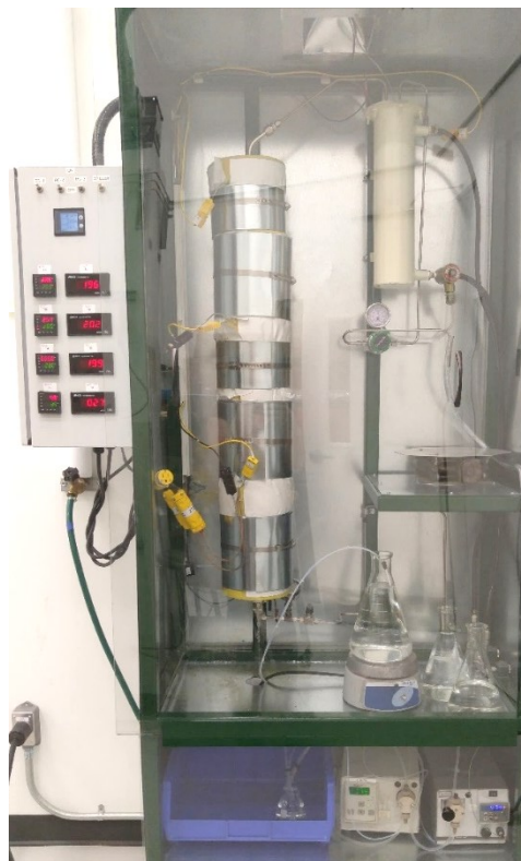
Figure III-4: Photo du réacteur tubulaire continu en Monel 400.
