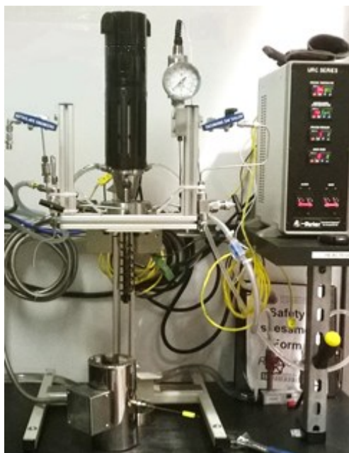
Figure III-1: Réacteur batch en Hastelloy de marque Autoclave Engineers (Parker), modèle de 300mL EZE-Seal® Closure.
