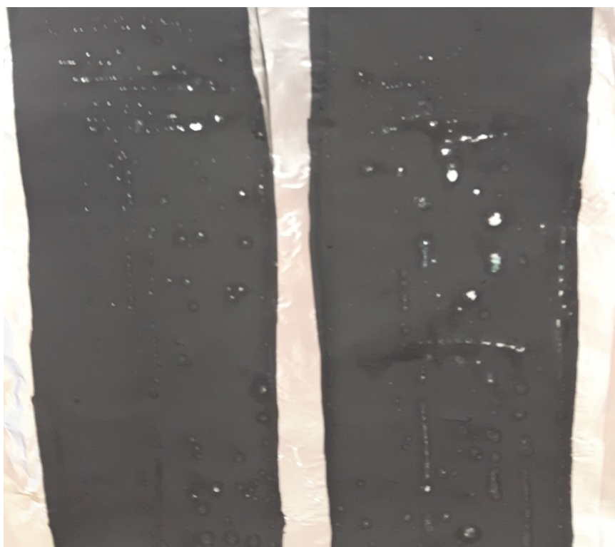
Figure 40. Deux enduits de cathodes secs sur une feuille d'aluminium. Les points blancs/gris à travers les enduits sont des trous à travers l'aluminium suite au séchage.
