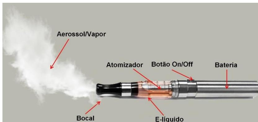
Figura 1.3 – Esquema geral de um cigarro eletrônico (adaptado).<sup>17</sup>
