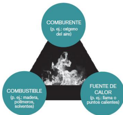
Ilustración 2. Tiángulo de la combustión . Fuente: (GERDAU CORSA, 2006)
