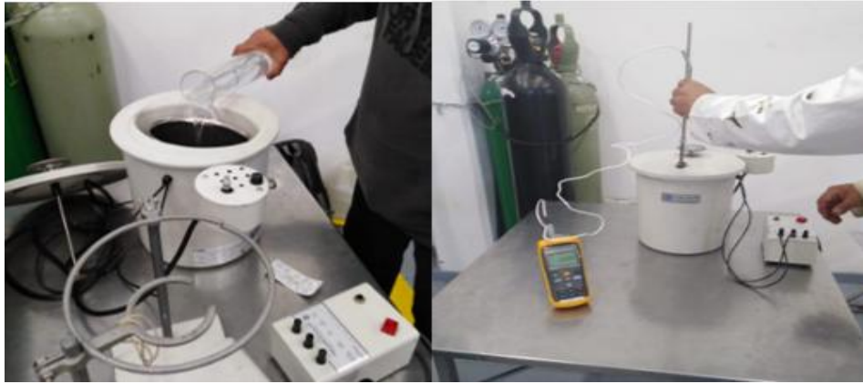
Ilustración 13. Montaje de la bomba calorimétrica
