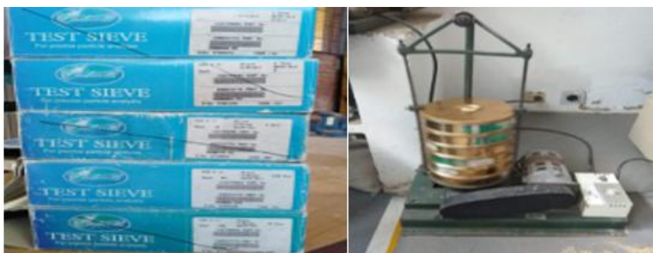
Ilustración 8. Montaje de tamizado
