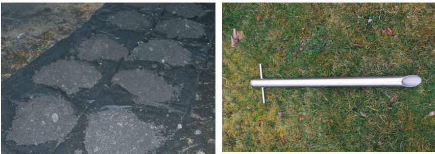
Abb. 2: Probenahme von Einzelproben (links), Spezialanfertigung Probenahmespeer für Brennstoffe und Aschen (rechts)
