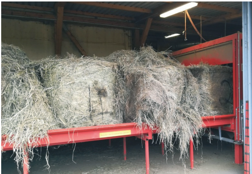
Abb. 5: Bestückung des Förderbands mit Niedermoorbiomasse-Rundballen (Foto: Kabengele)
