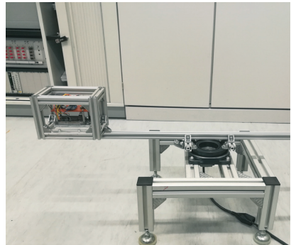
Abb. 8: Test der Beschleunigungskopplung am Drehtisch
