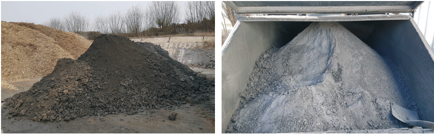
Abb. 1: Aschelagerung im losen Haufwerk (links), im Container (rechts)
