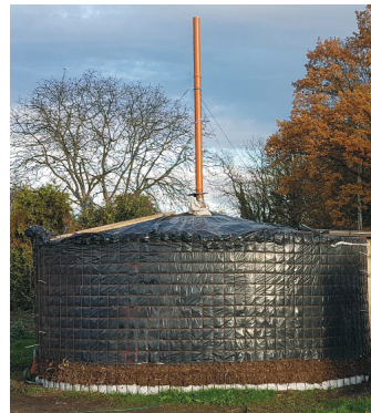
Abb. 2: Biomeiler 2.0 mit Dombelüftung
