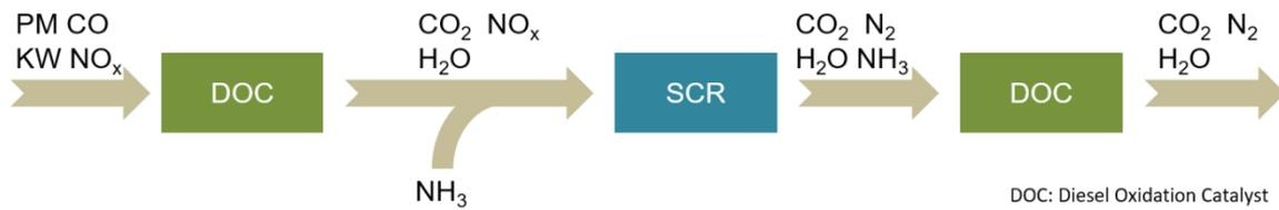
Abbildung 2.2: Aufbau einer Diesel-SCR-Anlage.
