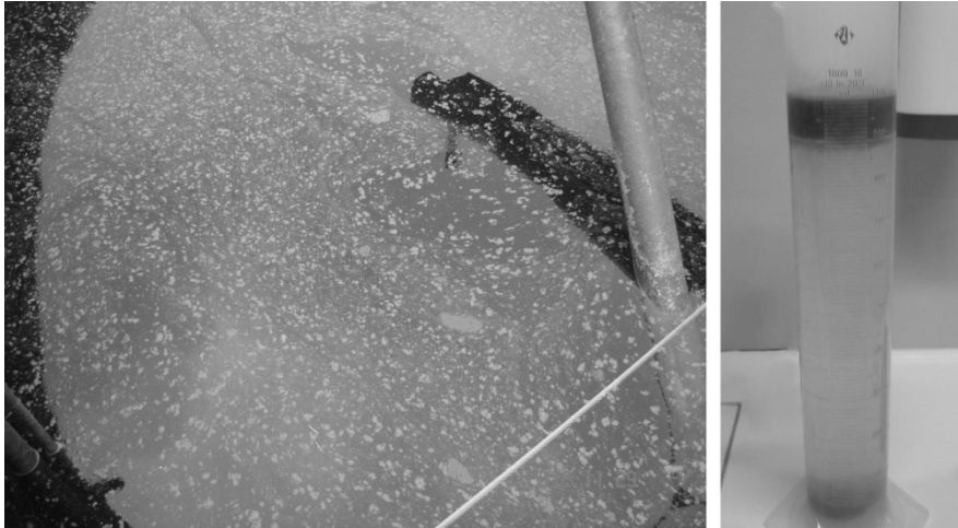
Abb. 5-28: Am Ende der Umstellung: Schwimmschlamm im SBR-Becken (links); Schlammvolumen nach 30 min Absetzzeit mit Verdünnung im Verhältnis 1:3 (rechts)
