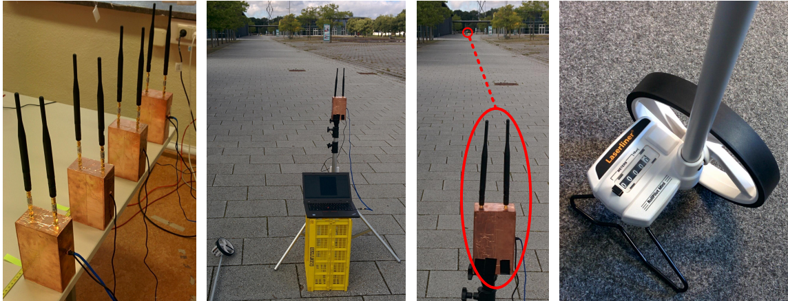
Abbildung 3.5: Indoor- und Outdoor-Reichweitenmessungen [B 6] (links: 3-Hop-Pfad Labor; Bilder Mitte: 1-Hop-Teilstrecke Messegelände; rechts: Messrad zur Outdoor-Distanzbestimmung)
