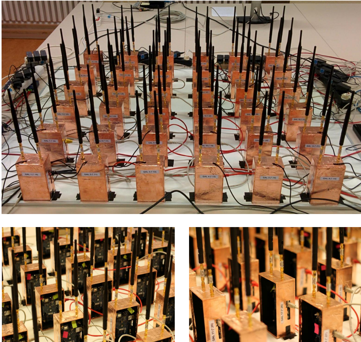
Abbildung 3.2: Testumgebung im Labor (oben: Gesamtansicht; unten links: Teilansicht Board-Einpassung im Gehäuse; unten rechts: Teilansicht Antennen-Dämpfungsglieder)
