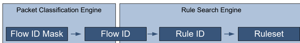
Abbildung 4.6: Funktionale Umsetzung der Packet Classification Engine
