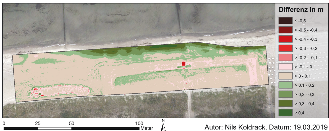
ABBILDUNG 5.3: Differenzmodell des Untersuchungsgebiets, zwischen 15. Dezember 2017 und 12. Januar 2018.
