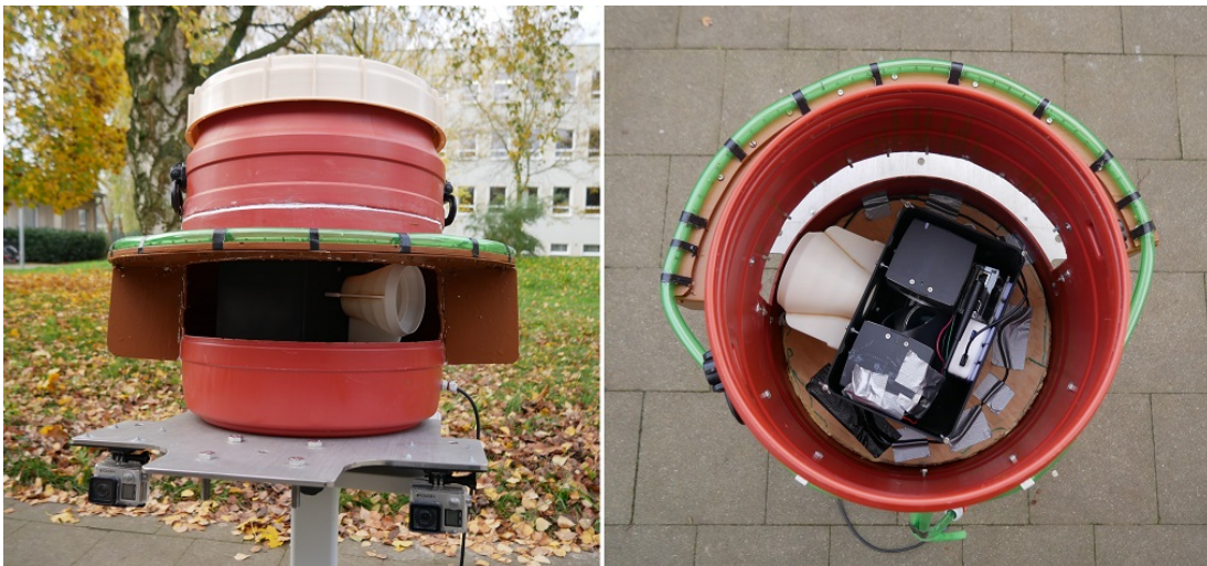
ABBILDUNG 3.11: Messvorrichtung, Weithalsfass mit eingesetzter TLS-Schutzhülle.
