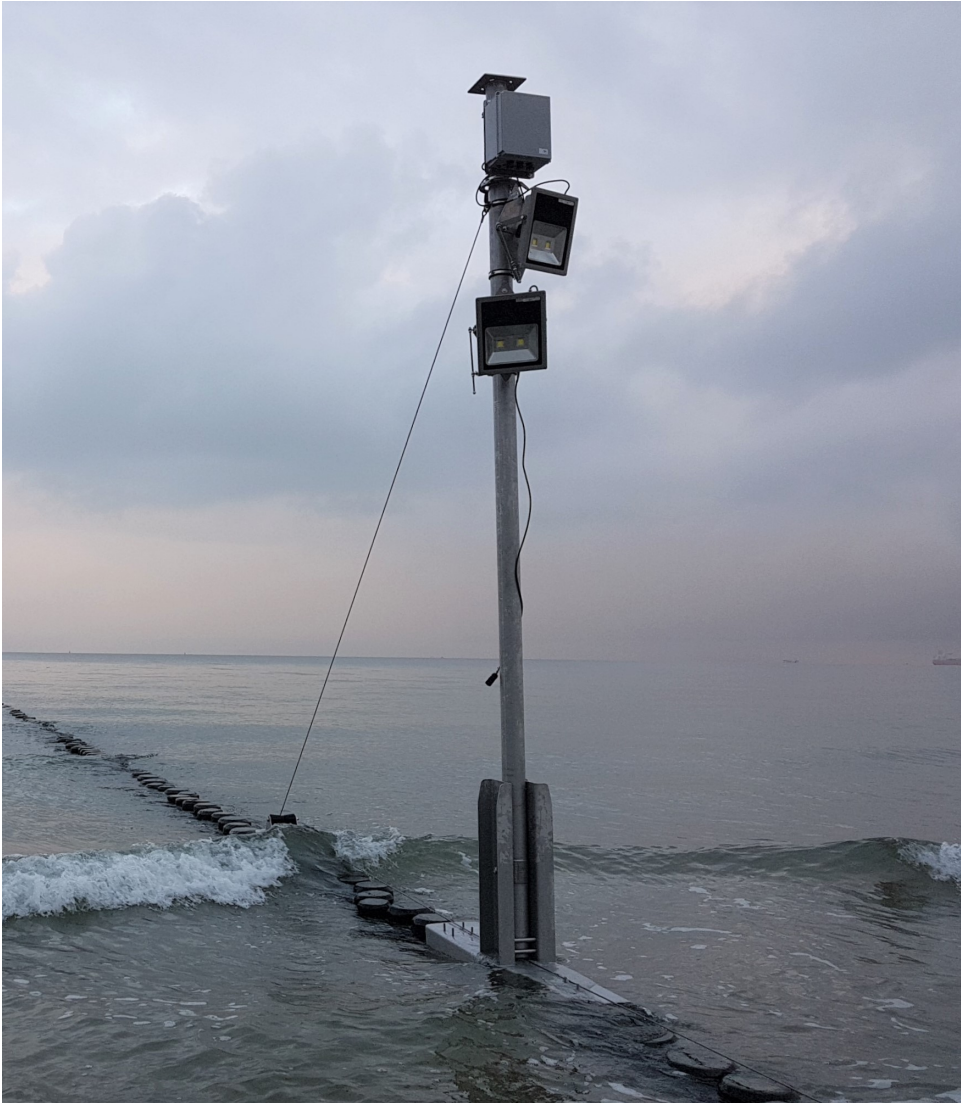
ABBILDUNG 3.8: Aufgerichteter Messpfahl ohne seitliche Abspannung und ohne Messvorrichtung.
