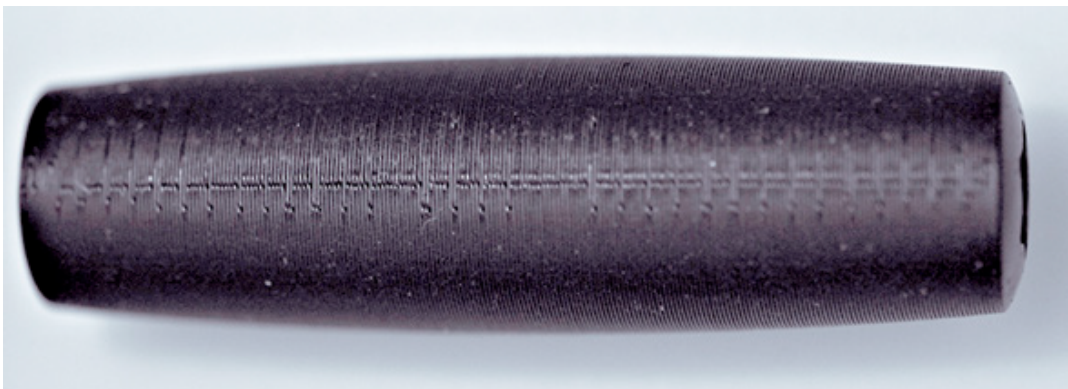
ABBILDUNG 2.11: Andruck und Welligkeit beim Extrusionsverfahren [73]
