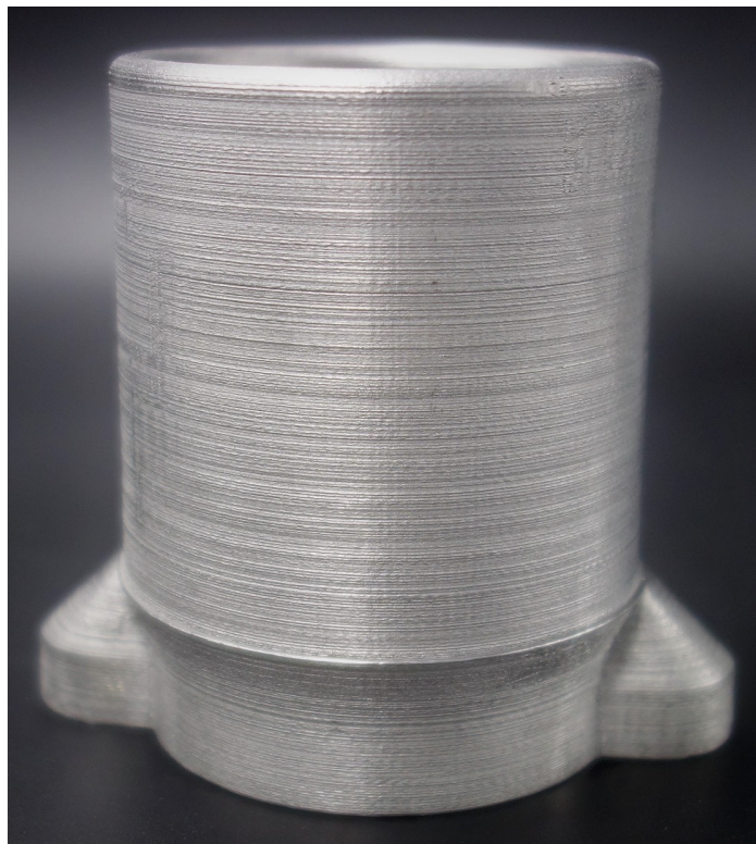
ABBILDUNG 8.1: 3D-gedruckte hydraulische Spannbuchse aus Metall, unbearbeitet
