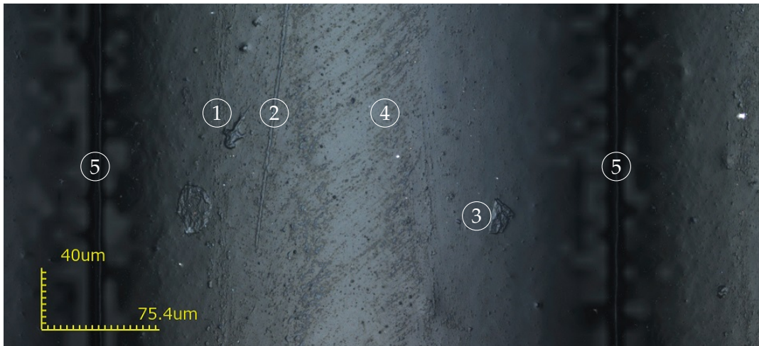
ABBILDUNG 4.11: Detailaufnahme der Oberfläche eines Probekörpers ohne chemische Behandlung
