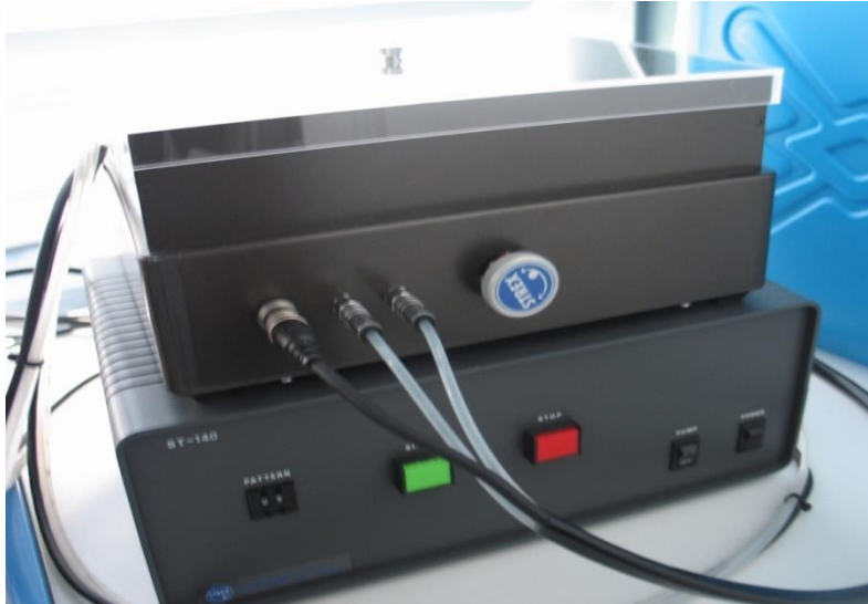
Abbildung 5: STREX Cell Strain Instrument zur mechanischen Stimulation von Zellen. Die Zellstimulation wird über zyklische Streckung von im Gerät eingespannten Silikonkammern ermöglicht.
