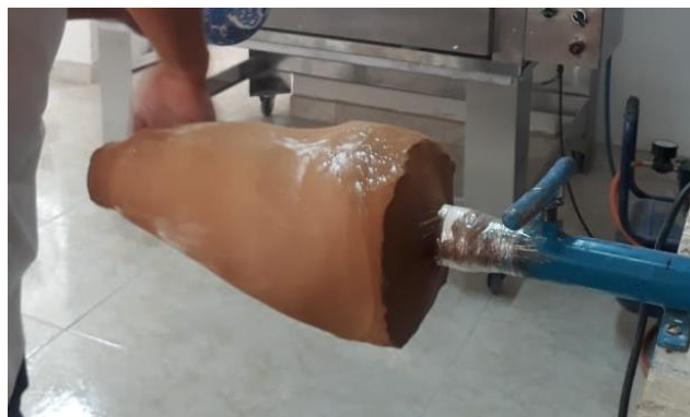
Figura 4.4. Preparación del molde para el termo formado.
