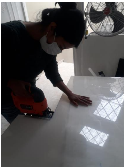
Figura 4.5. Corte del material polipropileno de 3 milímetros de espesor
