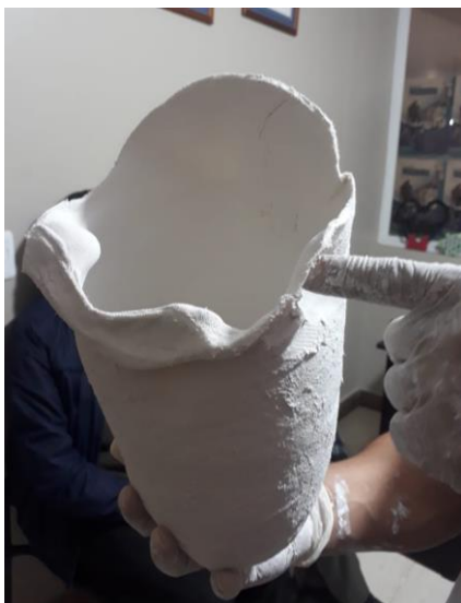
Figura 3.10. Molde obtenido en yeso [El autor]
