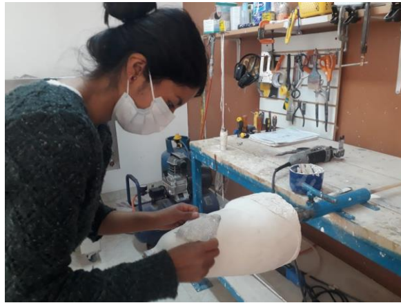
Figura 4.3. Acabado del molde "muñón de yeso"
