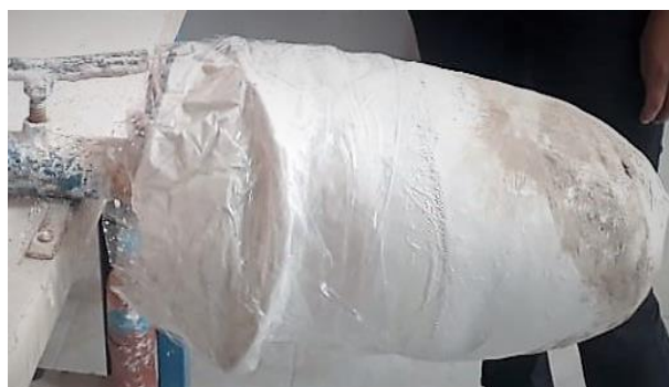
Figura 12. Molde relleno con yeso en su totalidad [El autor]
