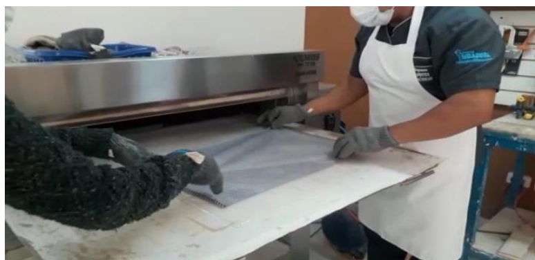
Figura 4.87. Adherir papel de diseño al polipropileno caliente
