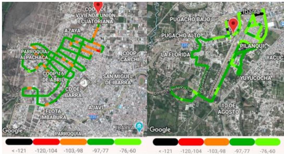
*Nota. En la figura se muestra el mapa de calor para la obtención de datos de cobertura de red.
