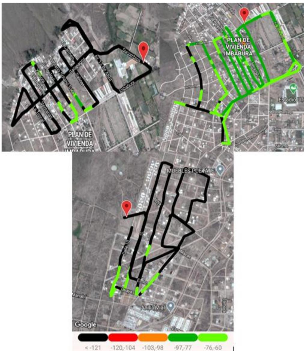
*Nota. En la figura se muestra el mapa de calor para la obtención de datos de cobertura de red.*
