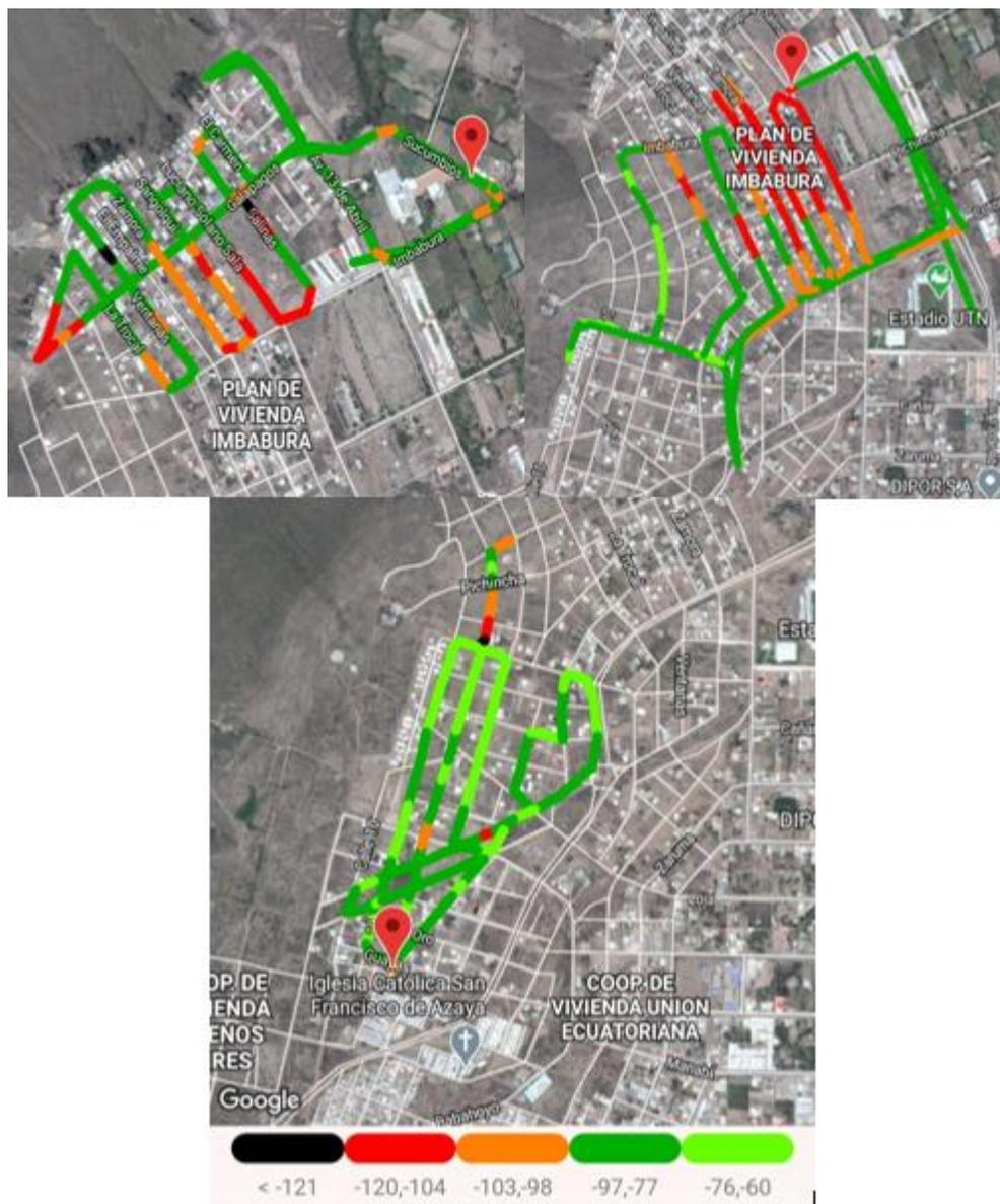
*Nota. En la figura se muestra el mapa de calor para la obtención de datos de cobertura de red.*
