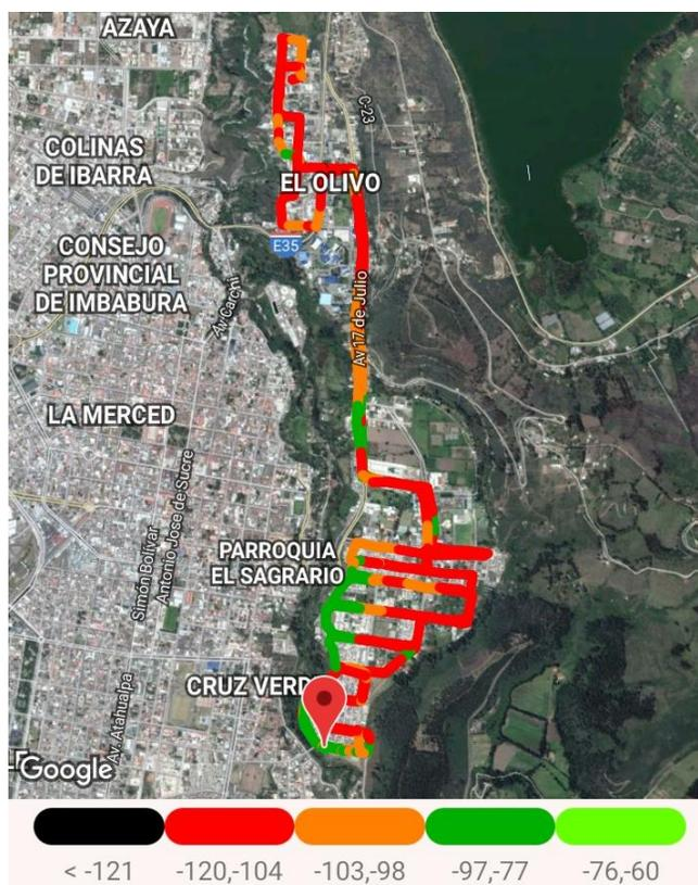
*Nota. En la figura se muestra el mapa de calor para la obtención de datos de cobertura de red.*
