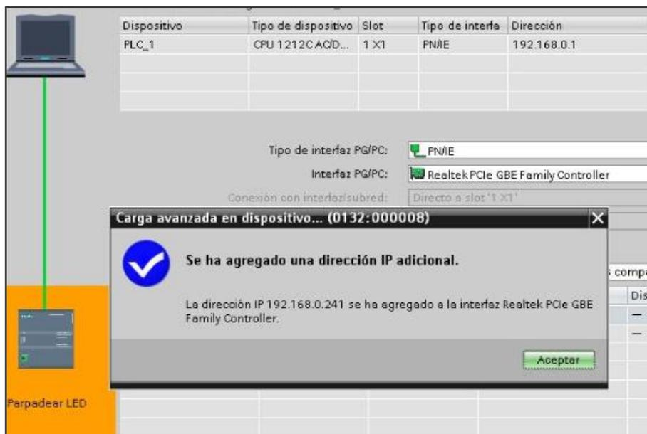
Figura 8.2.5 Base de datos cargada al dispositivo S7-1200 con una nueva IP.
