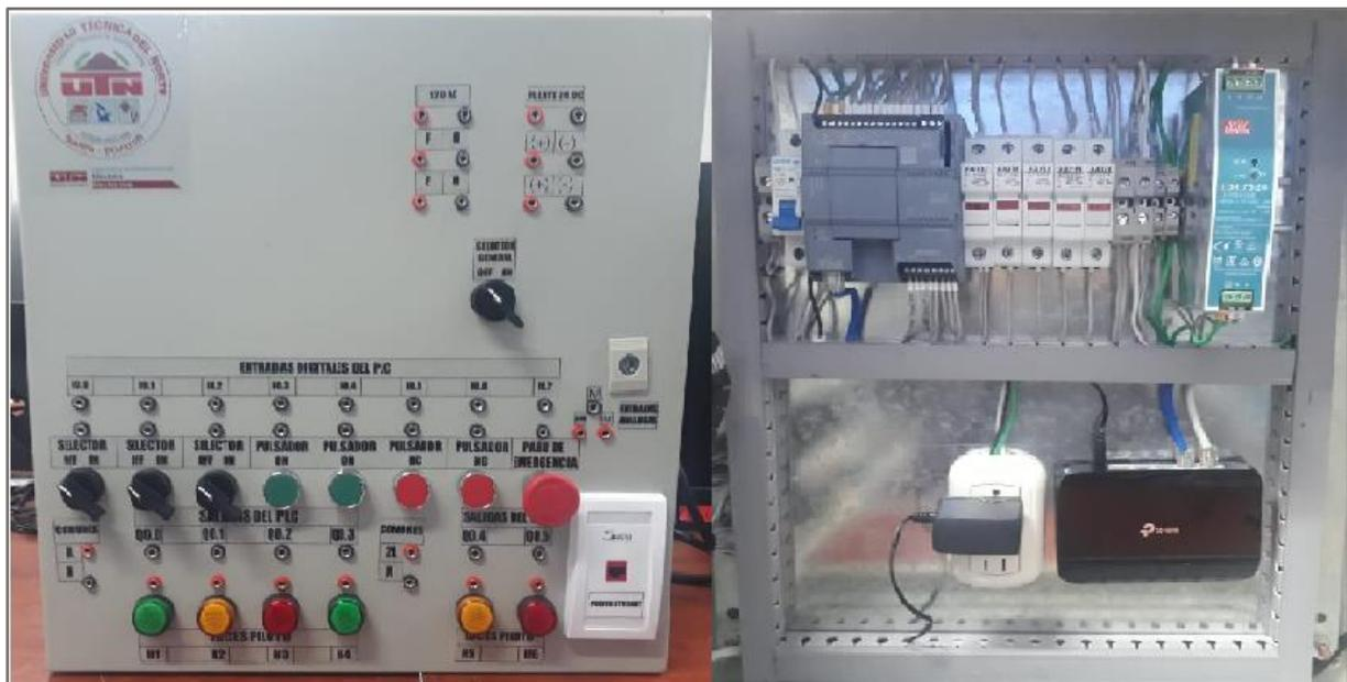
Figura 1 Estructura interna y externa del módulo PLC-S7-1200 SIEMENS
