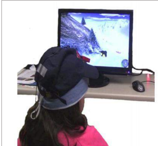
Figura 2.4 Sesión de entrenamiento con “Enlaza” colocado en una gorra de béisbol, controlando el juego “Extreme Tux Racer” [33].
