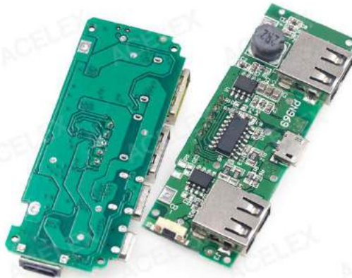
Figura 4.27 Placa de carga para batería de litio por Micro USB 5V – 1A.
