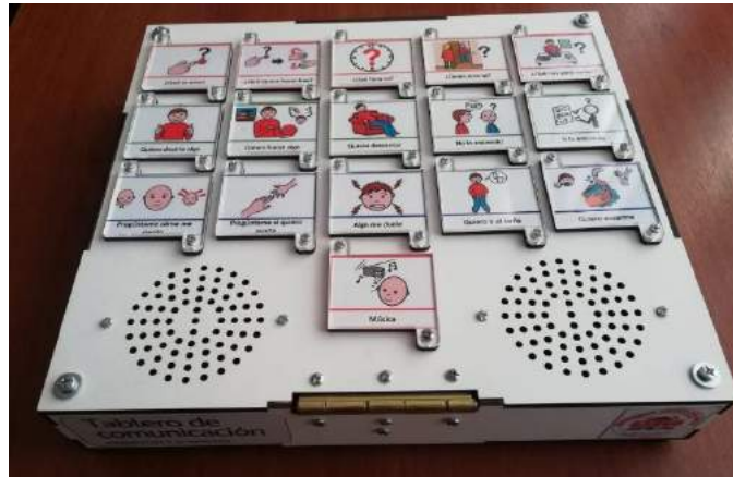
Figura 4.38 Ensamblaje del sistema tablero.
