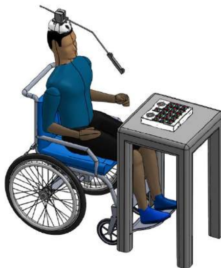
Figura 4.7 Dispositivo de apoyo para terapias de comunicación y aprendizaje en pacientes con parálisis cerebral.
