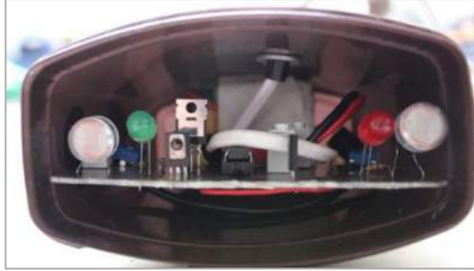
Figura 2.2 Interior de interruptor Diana para “Licornio Láser” donde se observa las dos zonas fotosensibles asociadas a los LEDs Rojo y Verde [31].
