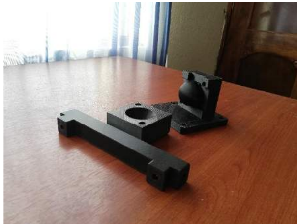
Figura 4.28 Base de sujeción impresa en 3D.
