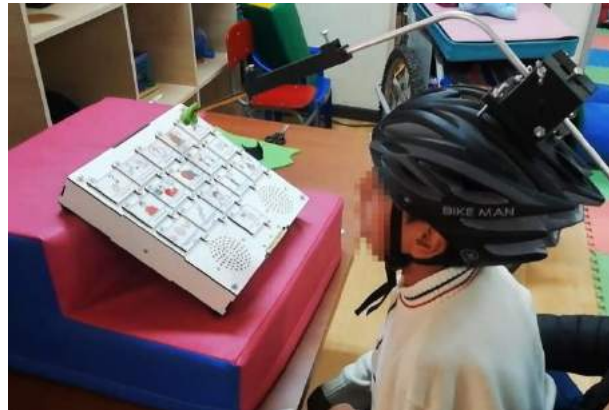
Figura 4.40 Pruebas de funcionamiento del sistema tablero.
