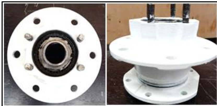
Fig. 27. Manzana usada como rodamiento del generador
