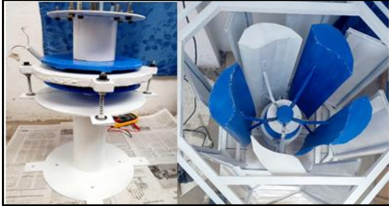
Fig. 35. Ensamblaje final de aerogenerador
