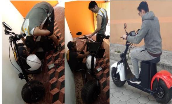
Fig. 3.5: Montaje del scooter eléctrico
