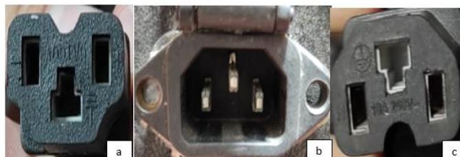
Fig. 3.7: a) Conector del cargador. b.) Conector del sistema hacia la batería. c) Conector de la batería hacia el controlador
