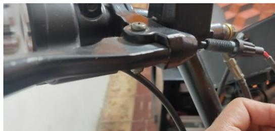
Fig. 3.12: Montaje del sensor de freno
