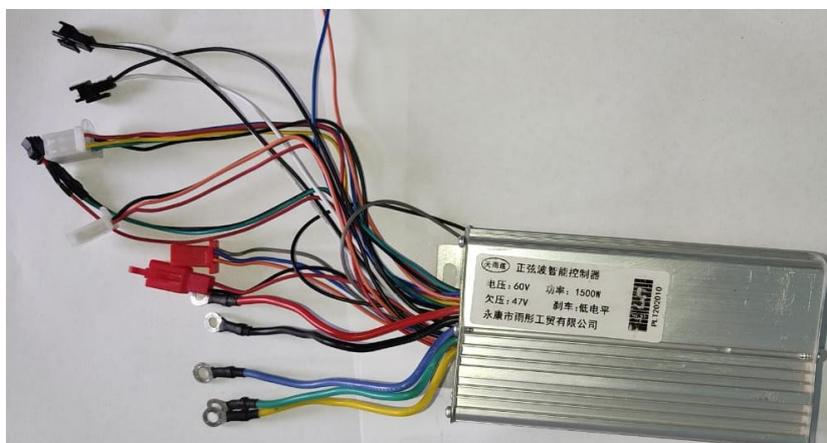
Fig. 2.4: Controlador de 1500 W a 60 V
