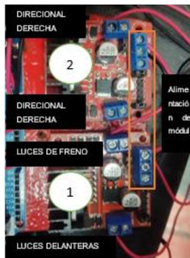
Fig. 3.10: Conexión de las luces del scooter
