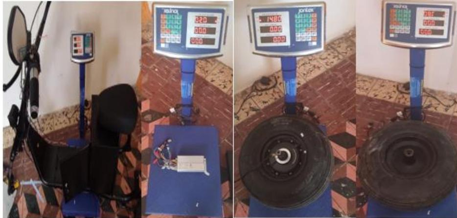
Fig. 3.19: Pesaje de los componentes
