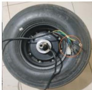
Fig. 3.2: Terminales del motor
