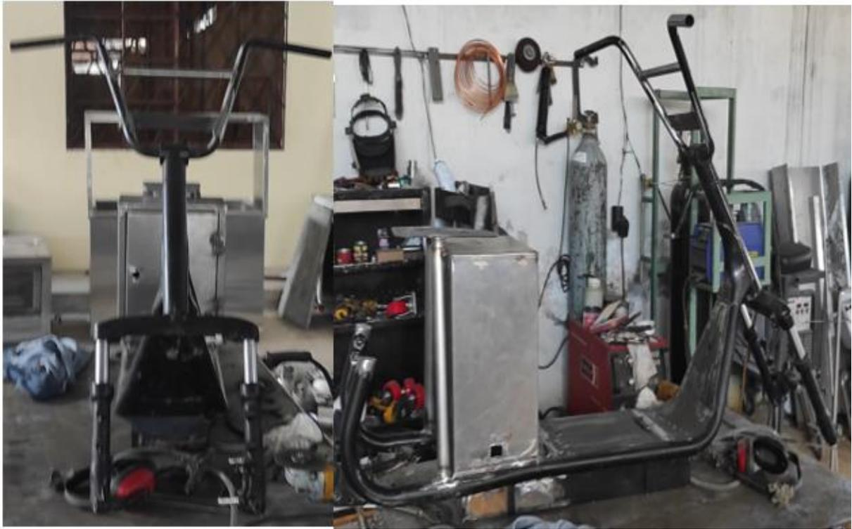
Fig. B3:Modificación scooter eléctrico
