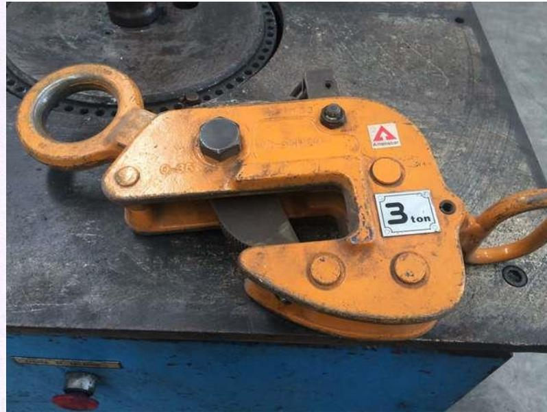
Figura 11. Pinzas para planchas de acero.
