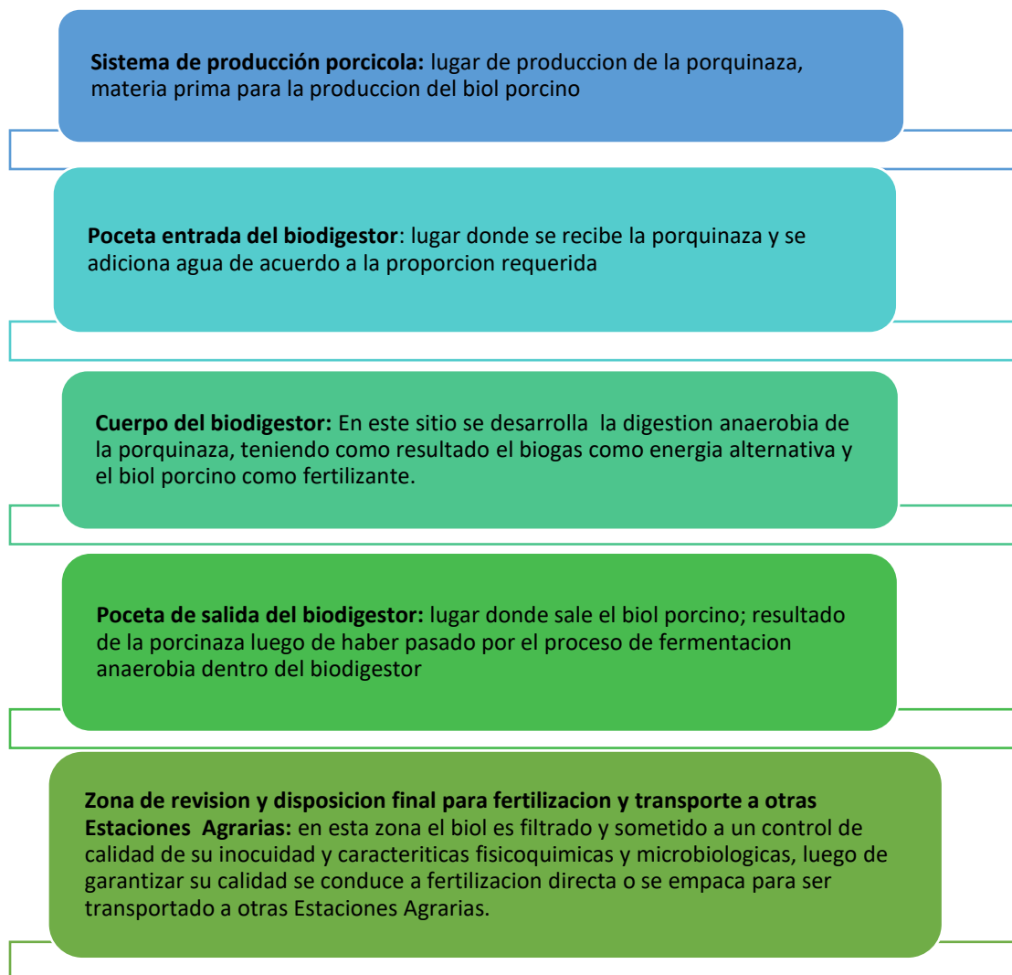
Figura 3. Esquema del proceso de producción del biol
