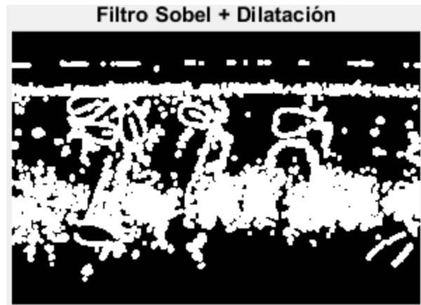
Figura 17. Resultado aplicación de técnicas Sobel y dilatación. (Autor).
