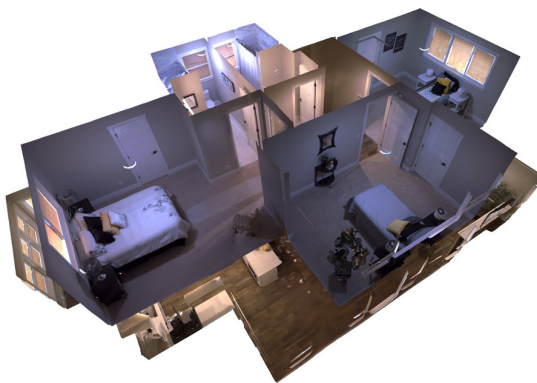
Figure 5: Las técnicas de visión geométrica por computador de última generación junto con los datos proporcionados por diferentes sensores pueden proporcionar reconstrucciones 3D de muy alta calidad. Arriba: reconstrucción dispersa ("sparse") mediante SfM basada en imágenes de turismo fotográfico [3]. Enmedio: reconstrucción de alta fidelidad con tecnología LIDAR [4]. Abajo: reconstrucciones de alta fidelidad realizadas con equipo profesional en Fig. 4 [2].
