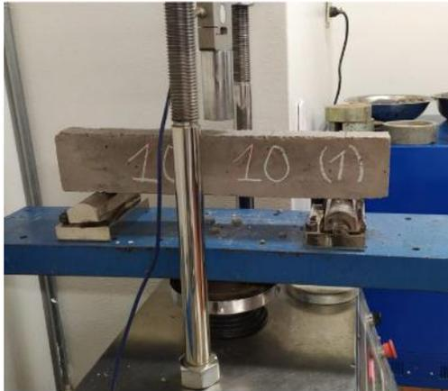
**Imagen 91:** Falla de Vigueta sin traslapo.
