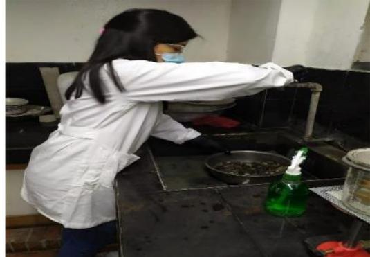
*Imagen 14: Lavado de los agregados.*
