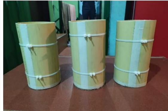
**Imagen 65:** Moldes finales para cilindros.
