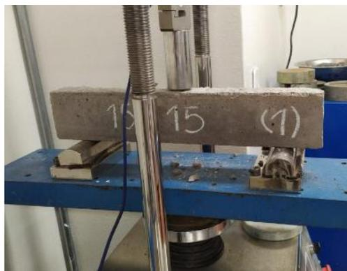
**Imagen 93:** Falla de vigueta con traslapo de 10cm.
