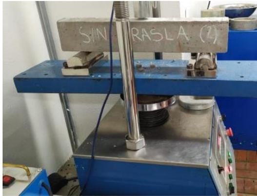
**Imagen 89:** Falla de vigueta de concreto convencional.
