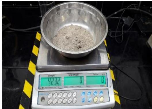
*Imagen 15: Peso del agregado fino.*
