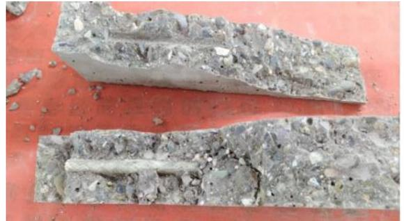
**Imagen 102:** Resultado del ensayo. Traslapo 20cm.
