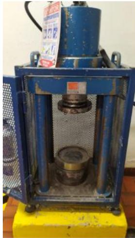
**Imagen 84:** Máquina universal de pruebas de resistencia para cilindros.
