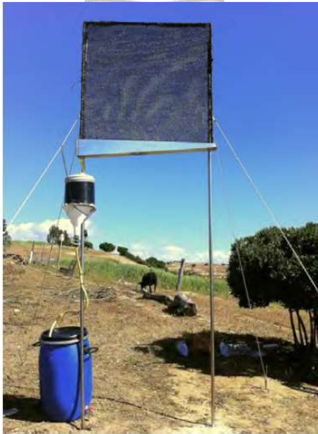
Ilustración 9: Estructura de atrapanieblas instalada en la Aguada a 203 msnm
