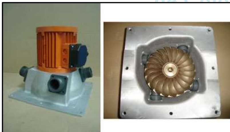
Fuente: interempresas.net: Micro central Vernis: energía hidráulica producida en casa
