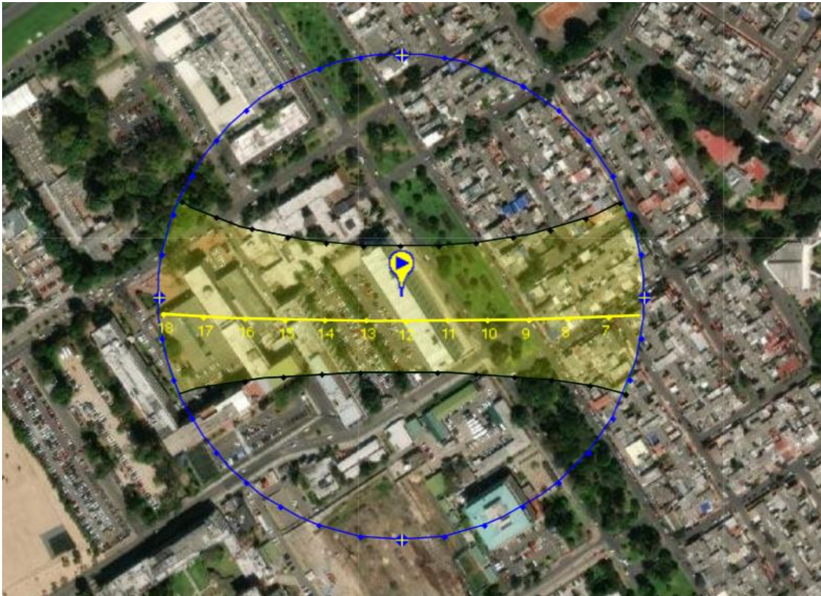
Ilustración 30. Trayectoria solar puntual sobre la edificación. Fuente: Elaboración propia a través de Earth Tools
