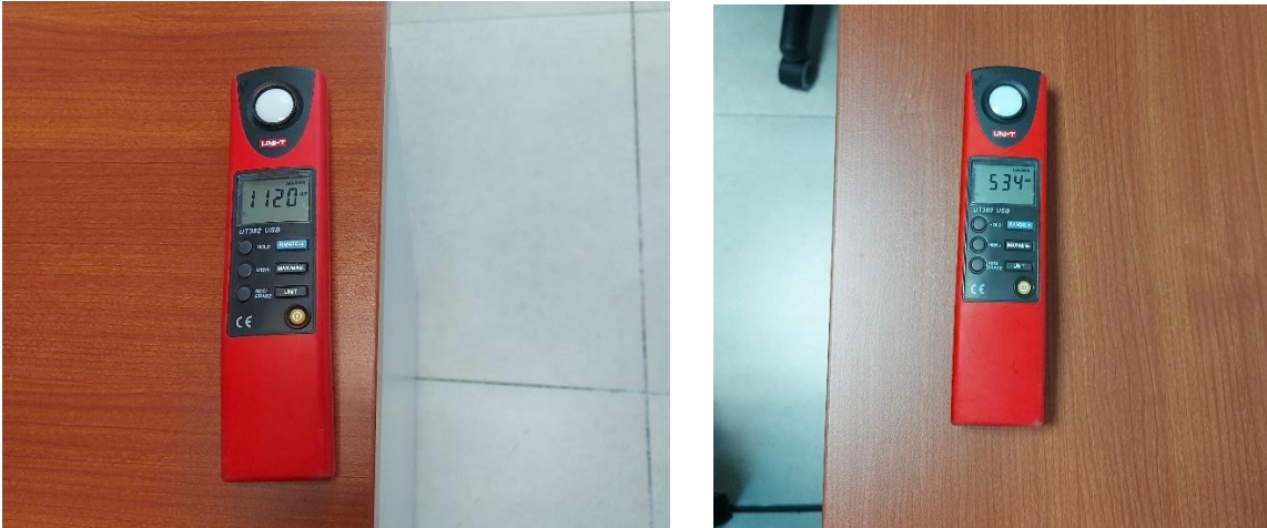
Ilustración 6. Registro de niveles de iluminación al interior del despacho central del piso 6.
