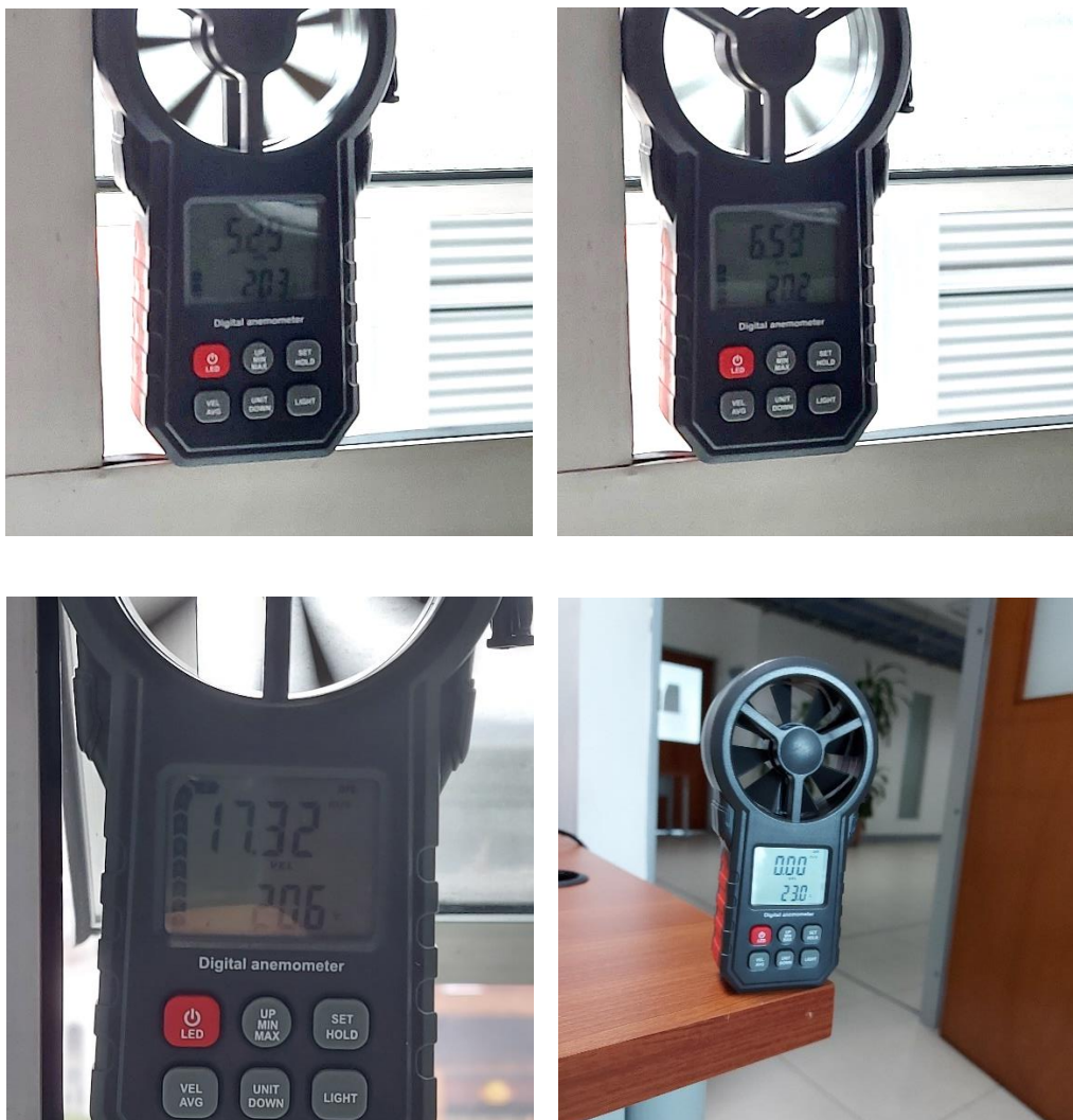
Ilustración 9. Mediciones de ventilación al interior del despacho central del piso seis.
