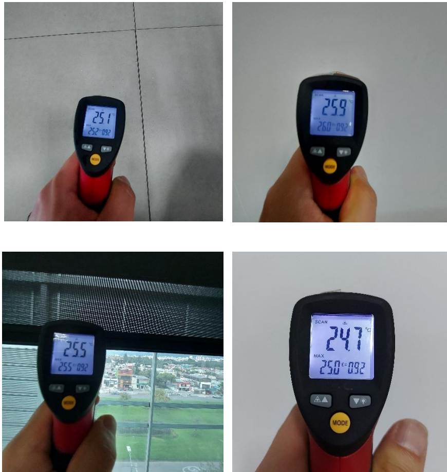
Ilustración 10. Medición de temperatura superficial de materiales (piso, muro, ventana y techo). Elaboración propia.
