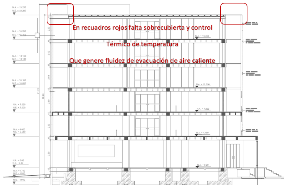
Ilustración 48. Remate cubierta zona de circulación de estratificación térmica. Fuente:
