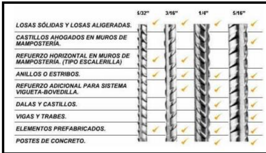
Ilustración 7: Tipos de varilla en acero y algunos de sus usos.
